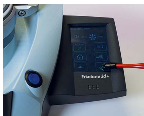
6. Avanti, termoformare*, girare il telaio porta dischi sotto il riscaldamento ...
