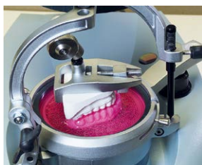
10. Chiudere l'Occluform-3 fino al arresto ed aspettare il tempo necessario per il raffreddamento.
