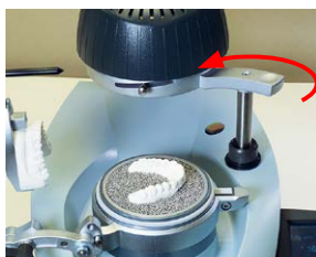
7. ... fino al bloccaggio (!) Inizia il processo di riscaldamento.
